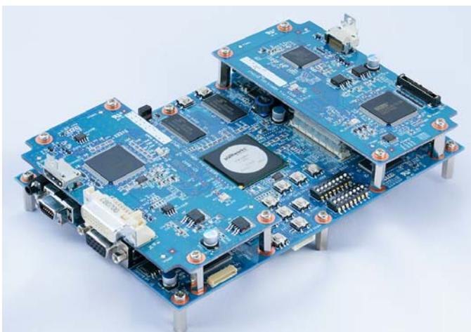
簡易信号発生機能付き映像エンジンモジュール
